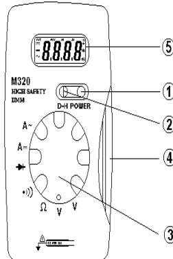
1. Кнопка включения. Нажатие кнопки включает и выключает прибор.
