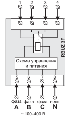
Схема 1. Упрощенная внутренняя схема и схема подключения
